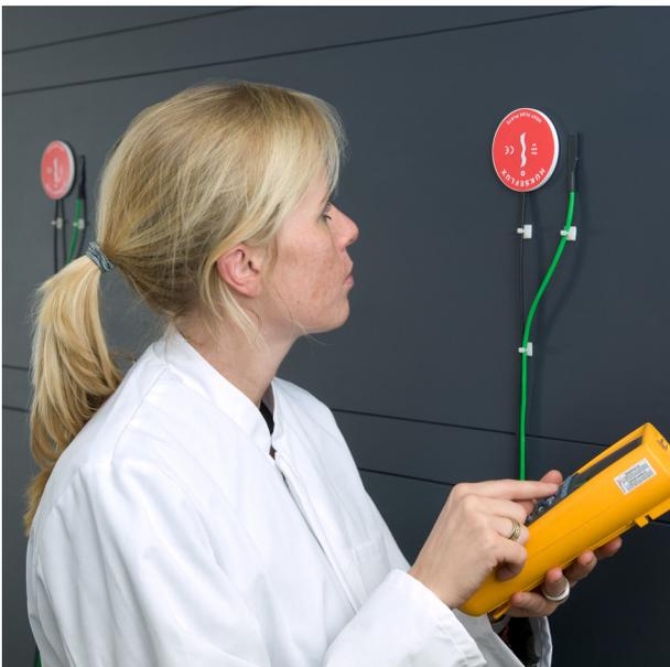
Figure 2 HFP01 热流量传感器在测量墙壁
