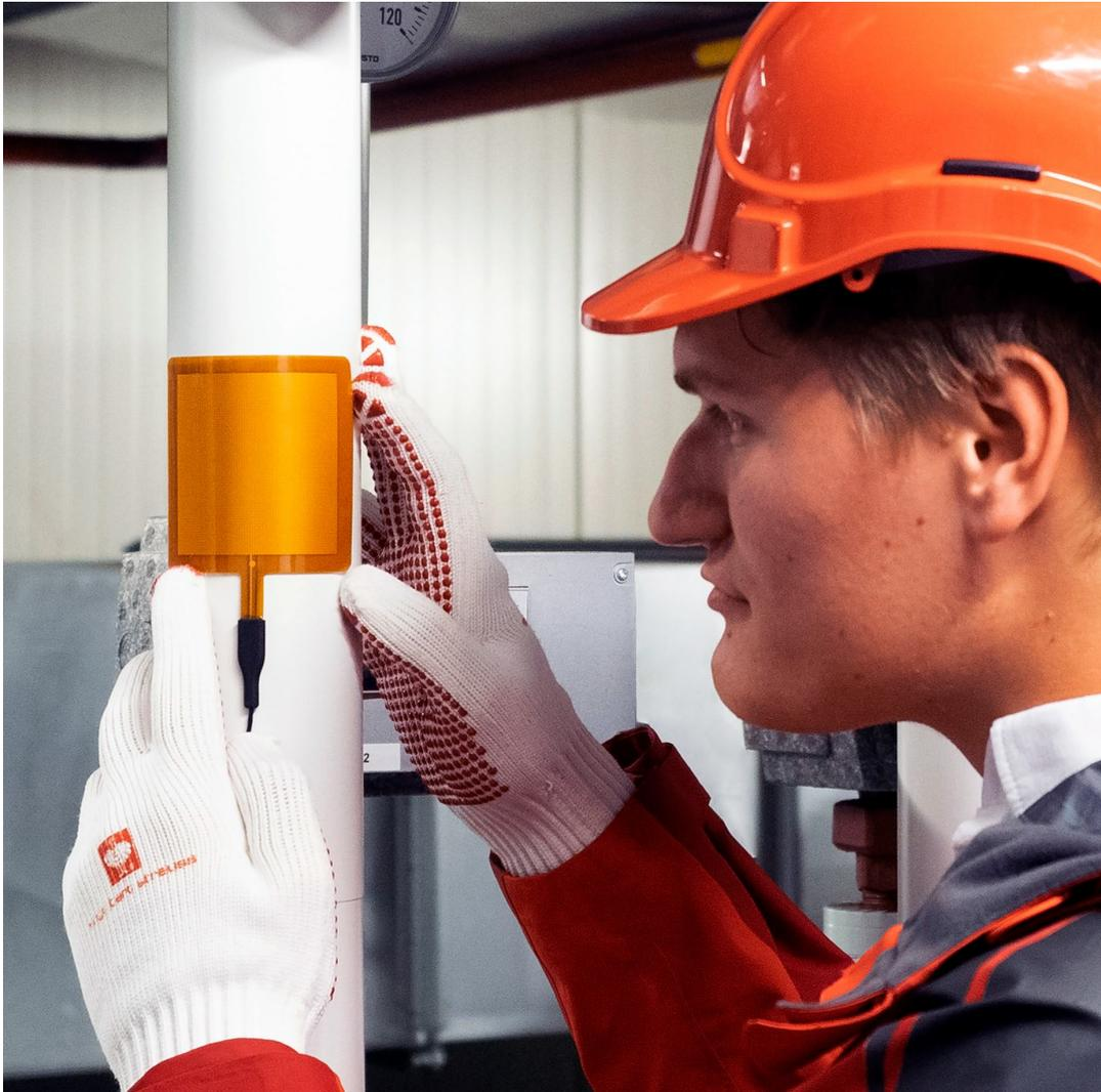
图 4.1.1 安装在工业管道上测量的 FHF05-85X85 型箔热通量传感器示例。将传感器安装在曲面上。
