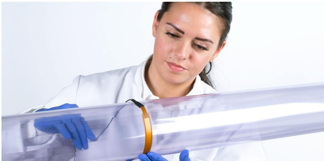
图02 FHF05-15X85型箔式热通量传感器，用于测量管道上的热通量。
