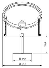
**Figure 3** SHR02 dimensions in  $\times$  10<sup>-3</sup> m
